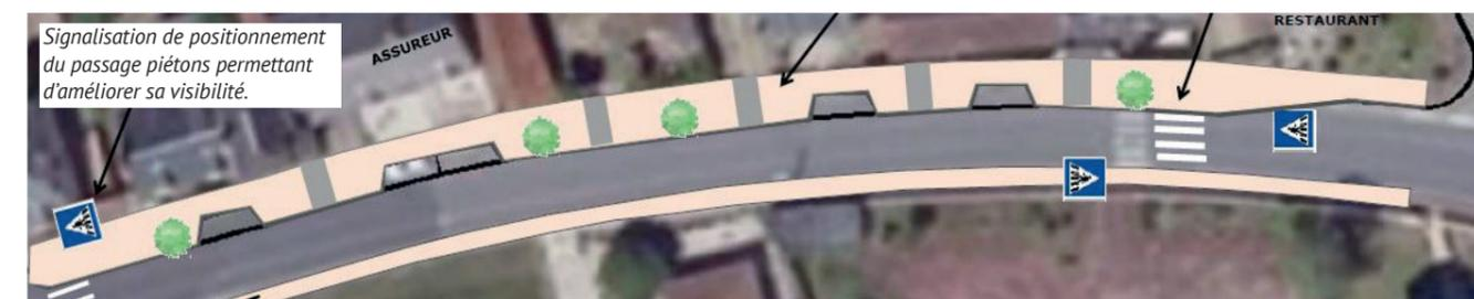
Des travaux d'élargissement des trottoirs permettront de rétrécir la largeur de la chaussée à la largeur réglementaire minimale de 6 mètres. Des places de stationnement en encoche dans le trottoir élargi seront créées. Un passage piétons sera créé en amont des places de stationnement. Il permet aux piétons de toujours marcher sur un trottoir avec une largeur minimum de 1,40m.
