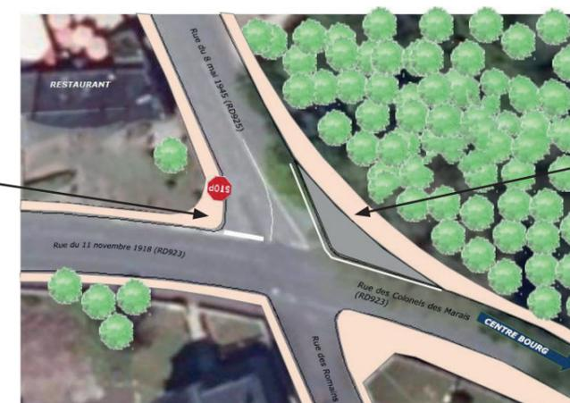
*Le trottoir est élargi. Un îlot franchissable (hauteur de vue environ 2 cm) et d'une couleur différente de l'enrobé (béton ou résine) permet de contraindre les VL tout en permettant aux engins de plus gros gabarit de le franchir pour accéder à la RD925 en venant du centre bourg.*
